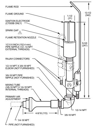
SPARK GAP BETWEEN IGNITION ELECTRODE AND GROUND MUST BE 1/8 TO 3/16 INCH (3.2 TO 4.8 mm).
